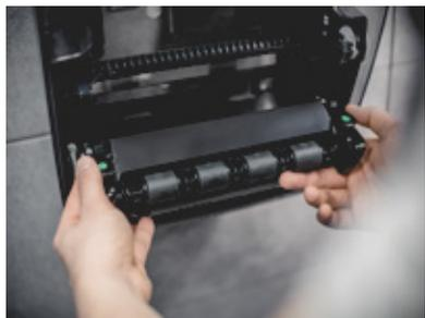
Les mécanismes de découpe s'ouvrent entièrement.
